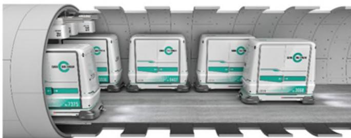
Die Fahrzeuge, die auf Rädern fahren und über einen elektrischen Antrieb verfügen, verkehren in dreispurigen Tunnels mit einer konstanten Geschwindigkeit von rund 30 Stundenkilometern. Der Gütertransport geschieht palettiert oder in angepassten Behältern. Dank kühlbaren Transportfahrzeugen ist auch der Transport von Frisch- und Kühlwaren möglich.
